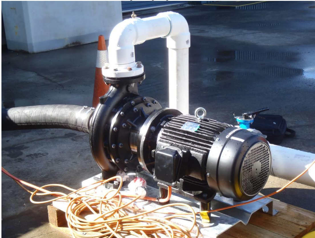
c) Grundfos NBG 125-100-315/279 3 phase pump
